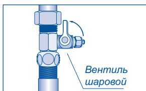
Для исполнения БАРЬЕР ПРОФИ Осмо Boost отключите электропитание повышающего насоса. Закройте кран накопительной ёмкости.
