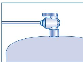
Откройте кран для чистой воды, чтобы сбросить давление, затем закройте кран.
