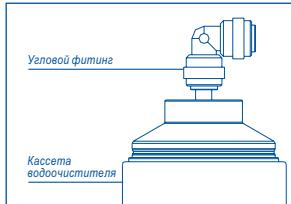
Установите корпус БАРЬЕР Минерализатор RO между тройником постфильтра и автопереключателем пластиковыми трубками. Для соединения пластиковой трубы с фитингом достаточно вставить трубку на 15–17 мм в фитинг.
