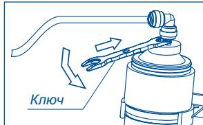
Распакуйте фильтроэлемент БАРЬЕР Минерализатор RO. Снимите транспортировочные колпачки. Наденьте угловые фитинги, идущие в комплекте, на трубчатые выступы фильтроэлемента.
